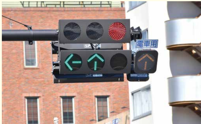
写真2 / LRT用の矢印が加わった信号機
