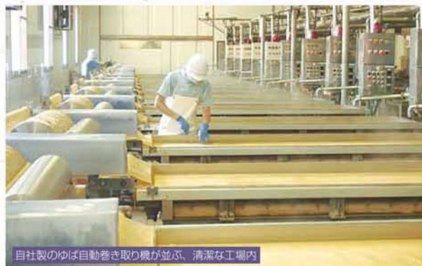
自社製のゆば自動巻き取り機が並ぶ、清潔な工場内
