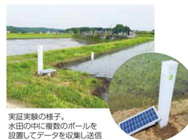
実証実験の様子。水田の中に複数のポールを設置してデータを収集し送信
