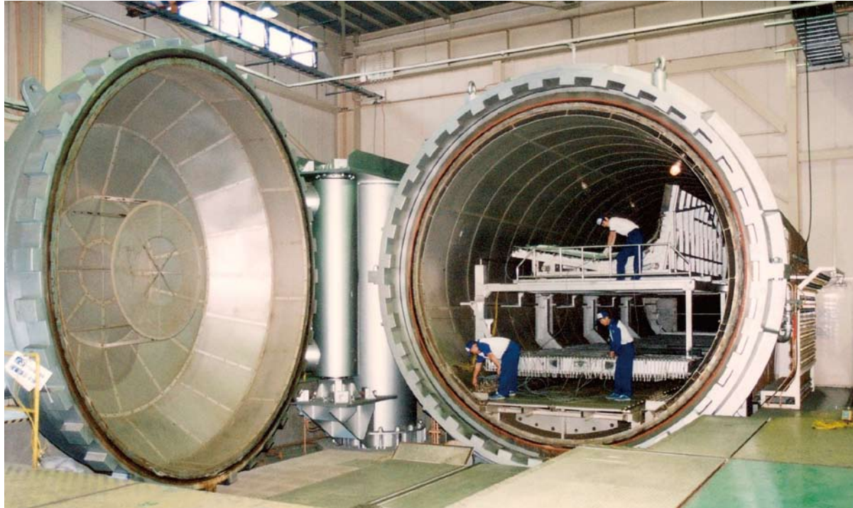
複合材の製造に使用するオートクレーブ(圧力釜)
