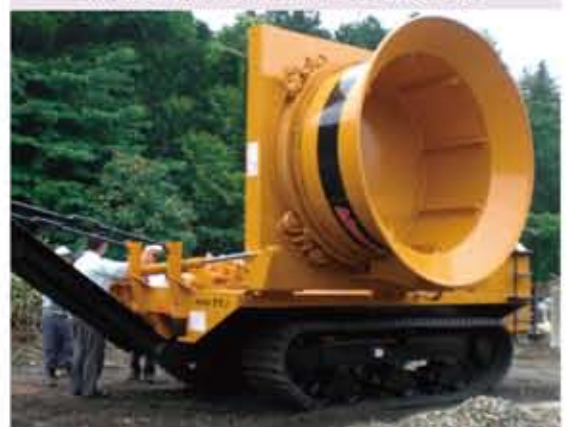
導入した大型粉砕機により、伐採作業現場での処理が可能
